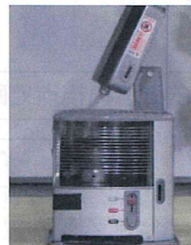
消火後に燃焼筒の温度が高温になっており、灯油がかり引火 (イメージ)
